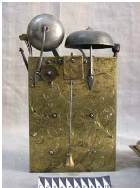
Ил. 2. Маятник «коровий хвост» консольных часов работы Джозефа Даддса
