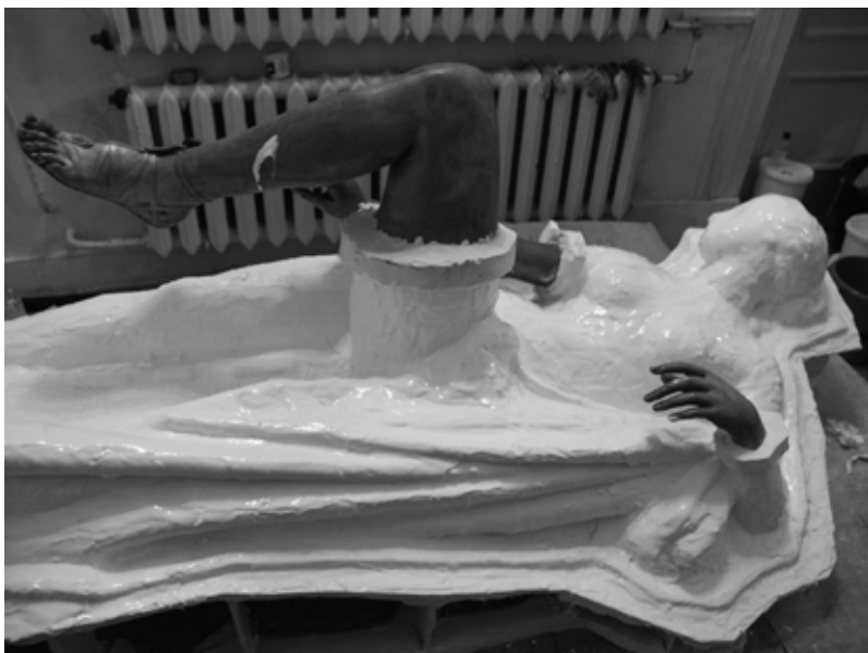
Ил. 3. Изготовление формы со скульптуры «Венера, снимающая сандалию» («Сергиевская») для отливки бронзовой копии. Декабрь 2008. Фотография
